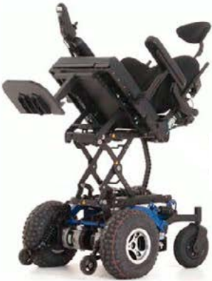
Elevación (30 cm) y basculación eléctrica 0°-45°
