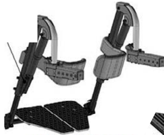
Reposapiés individuales, elevables eléctricos, abatibles
